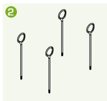
**2** Œillets de levage. Pour le transport à vide avec une grue
