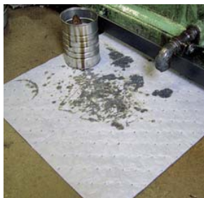
Feuilles MRO placées sous des joints et robinets qui fuient. Idéales pour recueillir les petits écoulements.
