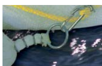
Attaches métalliques pour relier les barrages.
