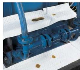
...ou encore autour ou sous les machines pour absorber les fuites et écoulements.
