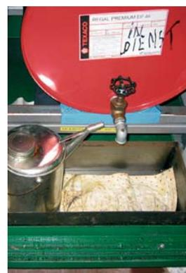
Feuilles OP placées sous des bidons et fût d'hydrocarbures pour recueillir les petits écoulements.
